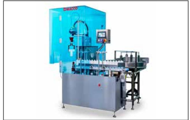
La linea "MRT-2-1/EL" lavora sia con flaconi/vasetti stabili che instabili, grazie all'utilizzo di Puck aperti con base standard e braccetti laterali modulabili; è in grado di processare prodotti semi-densi, densi, liquidi e schiumosi con volumi da 2ml a 1 Lt grazie a dosatrici volumetriche azionate da motori Brushless ed ugelli anti-goccia ad "inseguimento" o statici.
