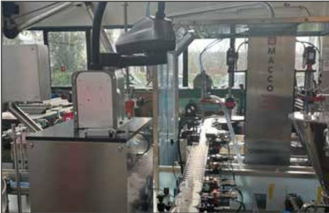
MACCO ha inoltre utilizzato una Smart Camera OMRON **MicroHAWK F430** che per le sue peculiarità - configurazione semplice con AutoVISION, sensore da 5 megapixel, messa a fuoco automatica, configurazioni di LED alternative - rappresenta una soluzione poco ingombrante e di facile utilizzo per il controllo formato, per il controllo presenza e per la verifica dell'orientamento nonché per piccoli controlli di qualità sull'integrità del flacone/vasetto.
