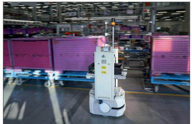
*Estos robots móviles autónomos están equipados con una torre transportadora, que consiste en un dispositivo de manipulación de cargas con altura regulable desarrollado por el integrador de sistemas cts GmbH.*
