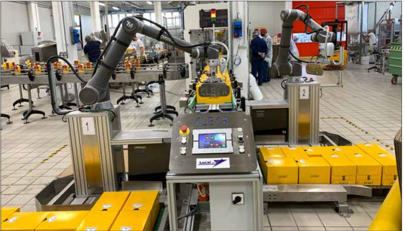
précis, une série de **capteurs intelligents basés sur des protocoles natifs de l'environnement IoT** a été placée pour analyser le système 24 heures sur 24, collecter les données de chaque station et les étudier en temps réel à l'aide du protocole MQTT.
