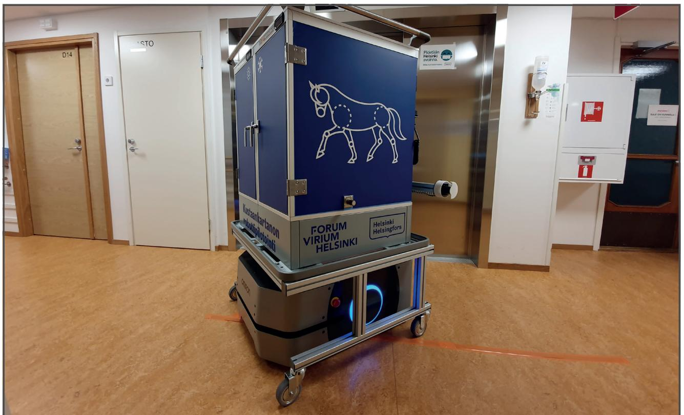
*Le robot mobile fonctionne comme un chariot de service, mais il peut également être utilisé pour transporter des repas et servir des plats.*
