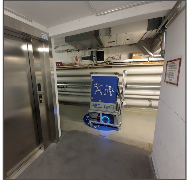
Mobil robot, Kustaankartano'nun servis tüneline, asansörlerde ve rampalarda bağımsız olarak gezinir.
