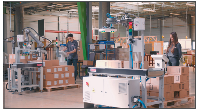
Es ermöglicht die Zusammenarbeit mit den Bedienern, die in sicherer Nähe zum Roboter arbeiten können, ohne dass ein Schutzzaun erforderlich ist.
