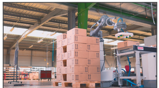
Diese Lösung entspricht den Anforderungen an automatisierte Palettierung, welche die Bediener bei dieser sich wiederholenden Aufgabe entlastet.
