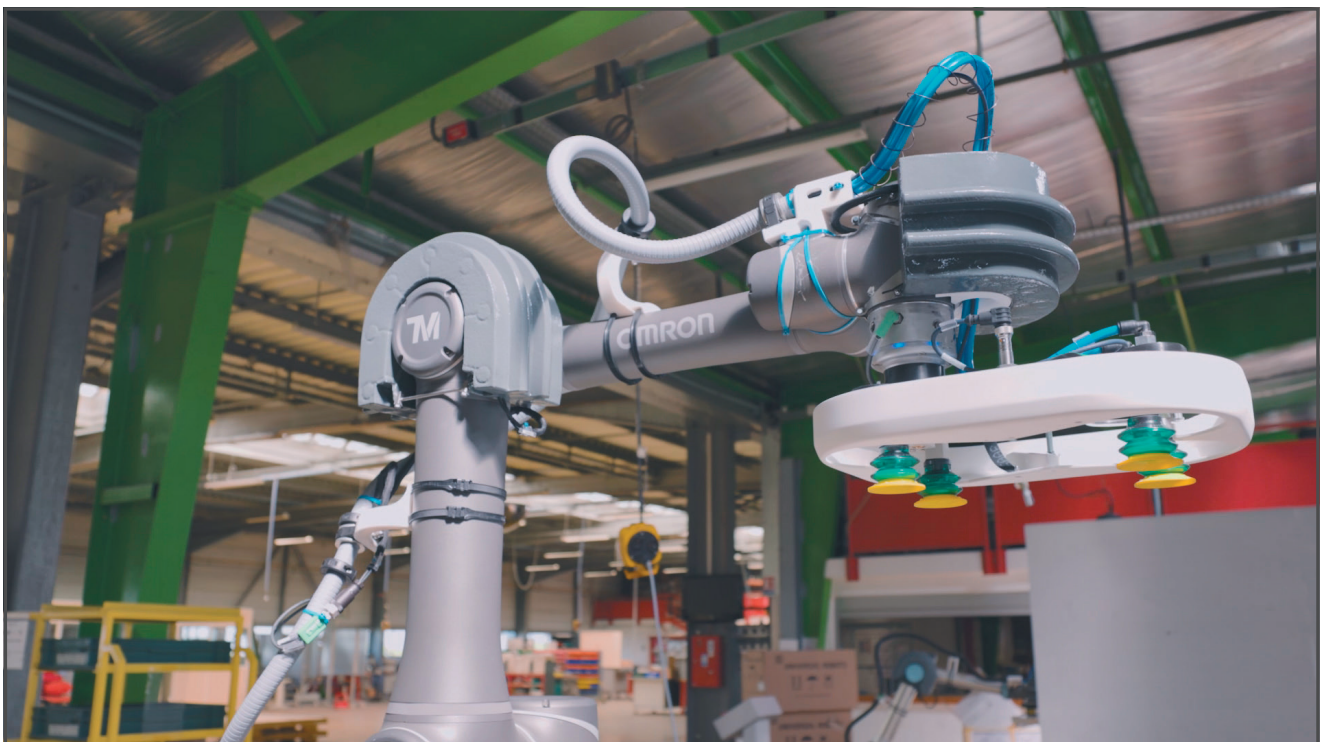
Die Cobot-Lösung mit geringem Platzbedarf und aktiver Sicherheitsausrüstung ermöglicht einen Durchsatz von bis zu acht Kartons pro Minute.
