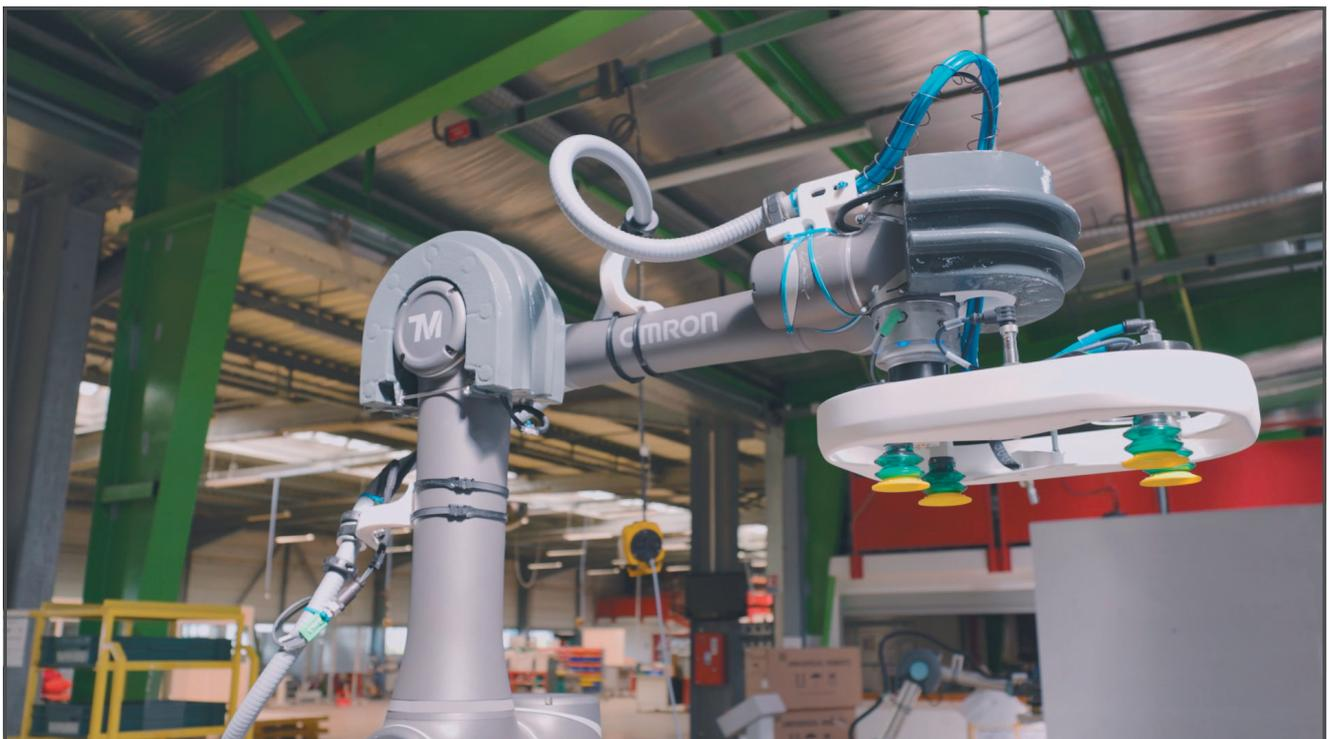
*La solución cobot con ingombro ridotto e apparecchiature di sicurezza attiva consente di gestire fino a 8 scatole al minuto.*
