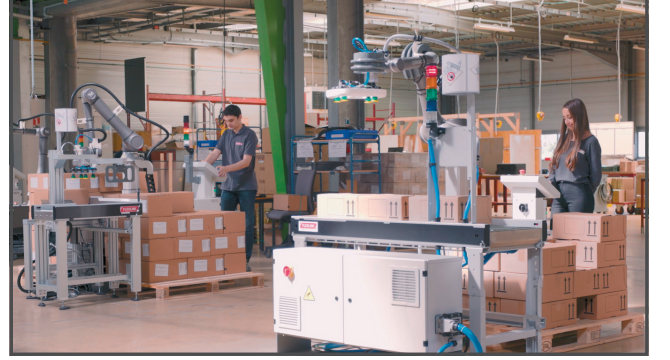
Bu sayede operatörler emniyet çiti veya lazer tarayıcılar kullanmadan cobot yakınında güvenli bir şekilde çalışabilir.
