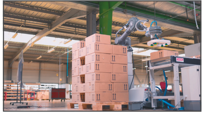
Bu çözüm, operatörleri bu tekrarlanan görevden kurtaran otomatik paletleme ihtiyacını karşılıyor.
