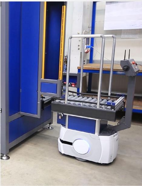
La funzione Precision Drive consente al robot di posizionarsi in modo molto accurato di fronte al nastro trasportatore. Inoltre, supporta procedure delicate di avvio e frenata, fondamentali per il trasporto di materiali fragili e costosi
