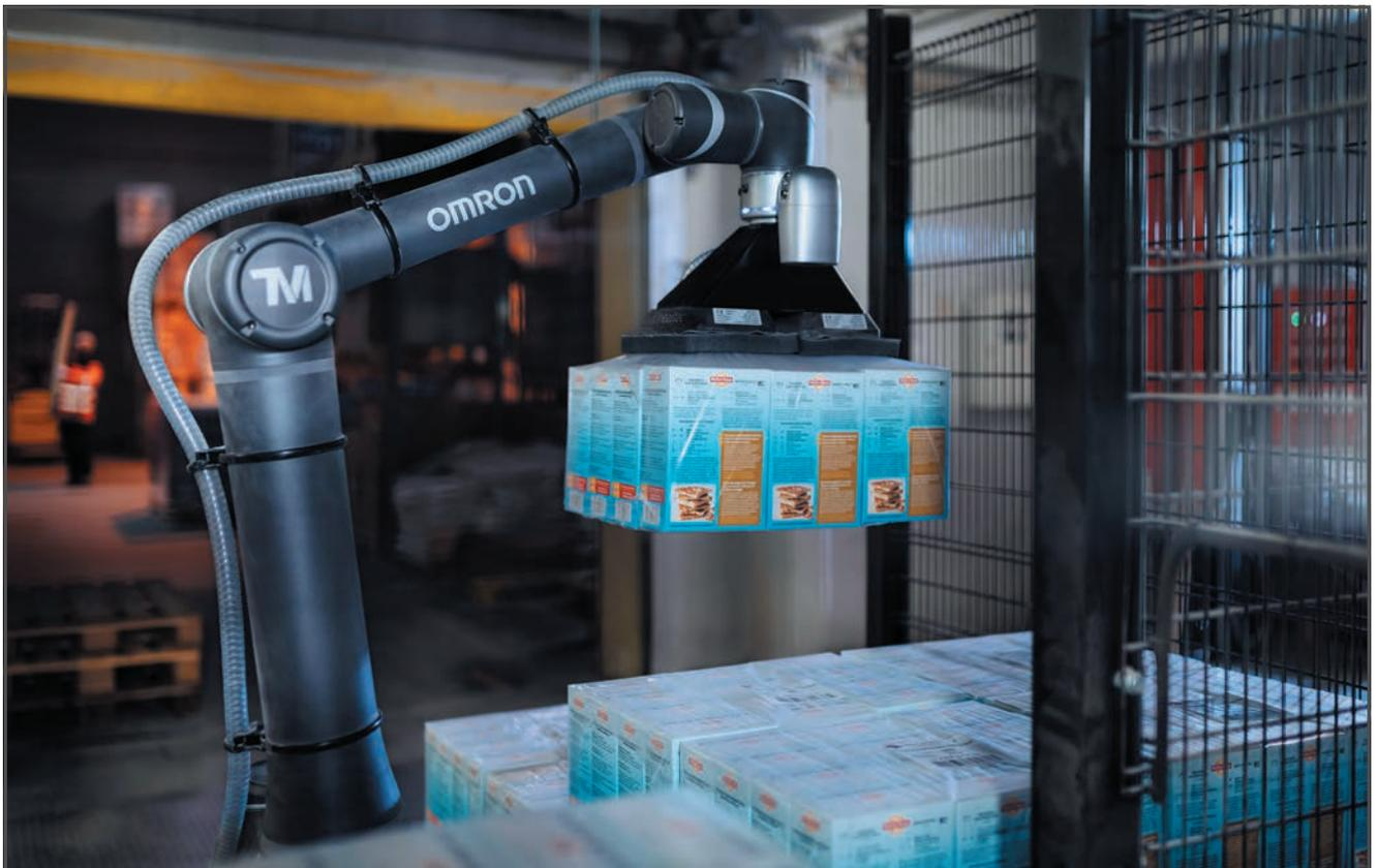
Le cobot OMRON TM12 dispose des meilleures fonctionnalités de portée et de charge utile de sa catégorie. Il peut atteindre 1 300 mm avec une charge utile maximale de 12 kg et une vitesse typique de 1,3 m/s. Il offre une solution automatisée, flexible et performante pour les opérations de fabrication. Ce cobot est doté de fonctions de sécurité et d'un système de vision intégrés. La caméra intégrée peut reconnaître les objets dans presque toutes les conditions d'éclairage.
