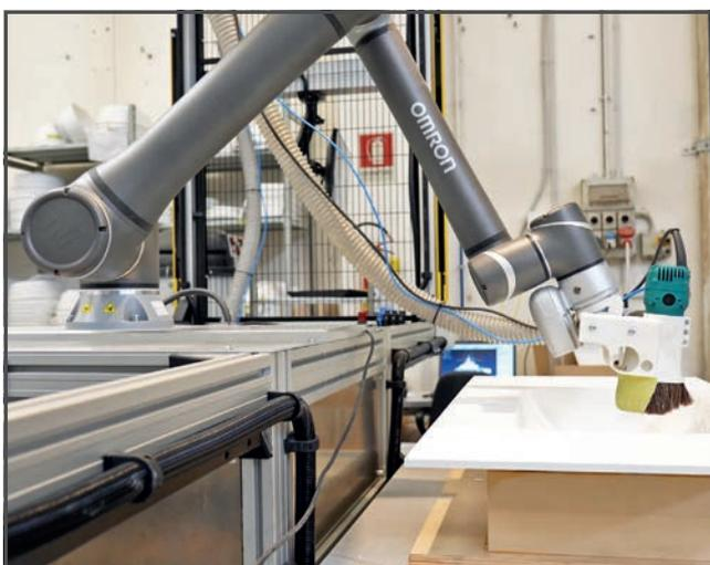
*El nuevo robot permite automatizar todas las operaciones de acabado de los productos Topcustom fabricados con Ocritech.*
