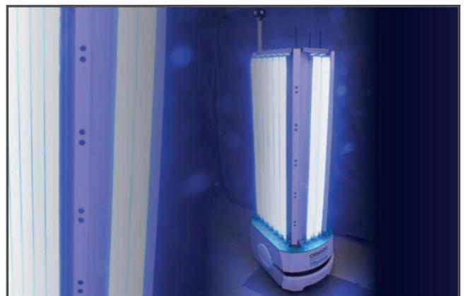
*Compuesto por una serie de lámparas UV-C de alta precisión desarrolladas por Phillips y montadas sobre una plataforma de robot móvil OMRON de última generación, el robot UV-C es capaz de recorrer de forma autónoma las zonas de una instalación.*
